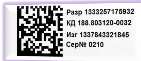
Рисунок 3 - Маркировка номерного изделия уникальным идентификатором с использованием кодов ОГРН разработчика и изготовителя
