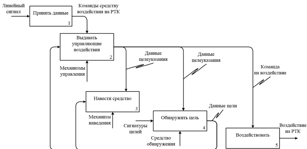
Рисунок 5 – Декомпозиция блока А3 «Воздействовать на РТК»
