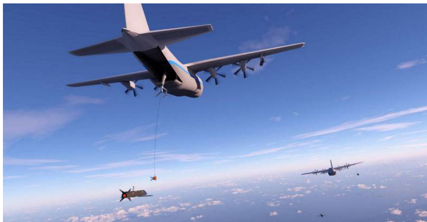
Рисунок 5 – Схема возвращения беспилотного летательного аппарата на борт носителя с помощью захвата
