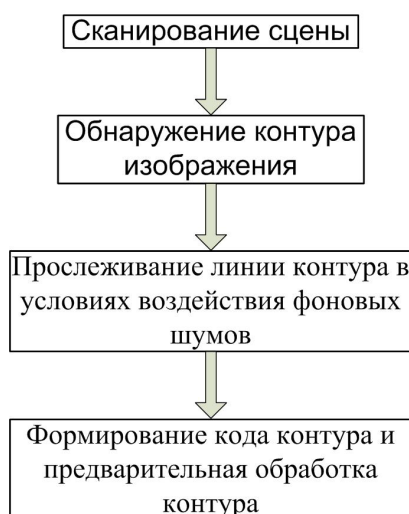
Рисунок 2 – Определение контура объектов
