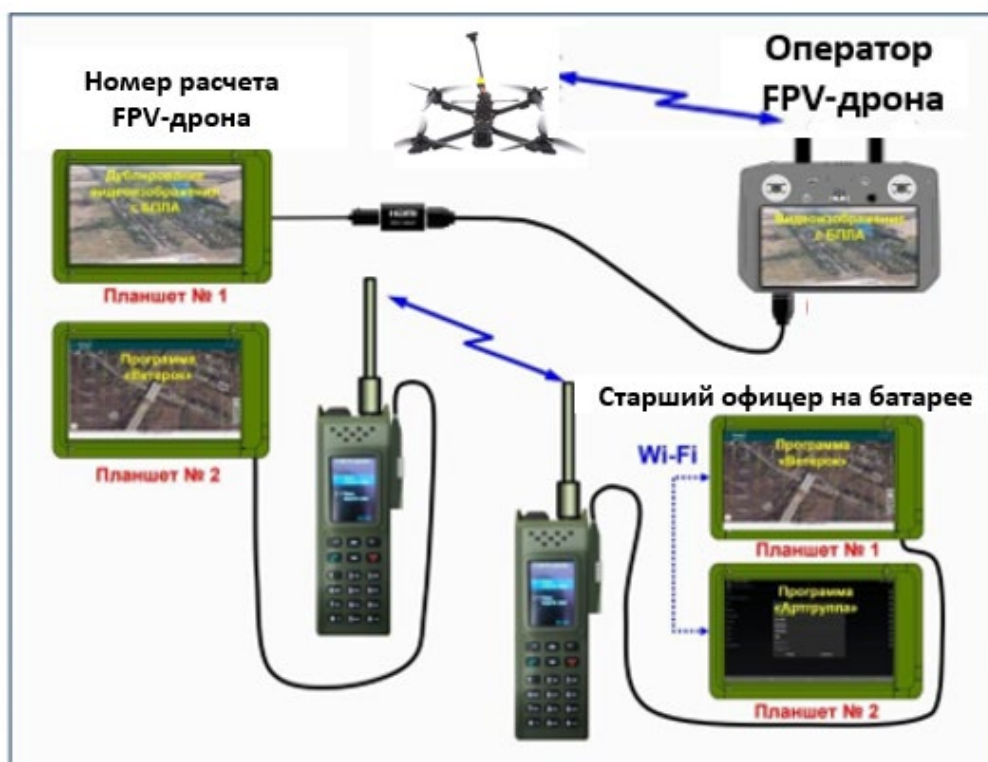
Рисунок 3 – Схема программно-аппаратного комплекса корректировки артиллерийского огня с применением FPV-дронов
