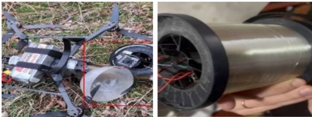
Рисунок 2 – Общий вид катушки с оптоволоконным кабелем и место ее размещения на FPV-дроне
