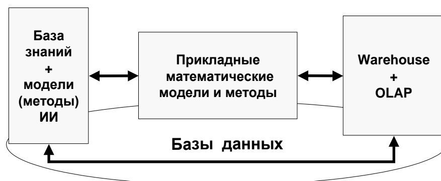
Рисунок 5 – Структура системы поддержки принятия решений
