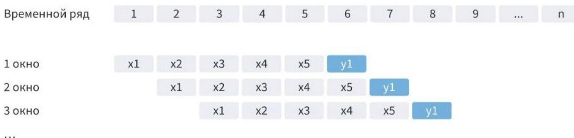
Рисунок 2 – Иллюстрация работы алгоритма скользящего окна
