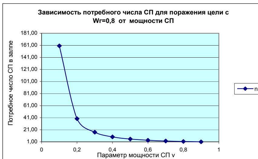
Рисунок 8 – Зависимость потребного числа СП для поражения цели с W_G = 0,8 от мощности СП
