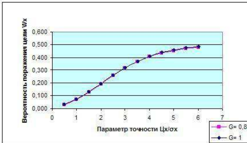
Рисунок 4 – Графики зависимости вероятностей поражения цели для ЗП с параметрами \bar{G}=1 ; \bar{G}=0,8 ; l_x^*/C_x=0,5
