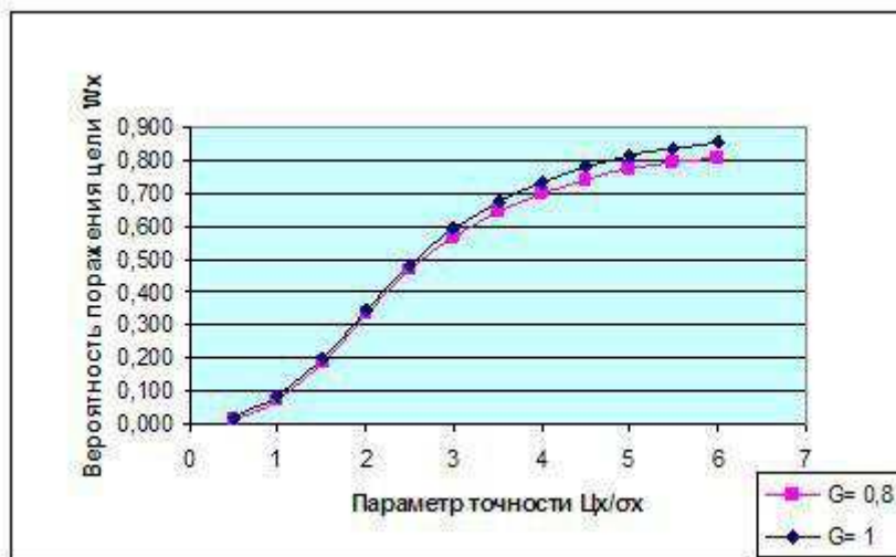
Рисунок 5 – Графики зависимости вероятностей поражения цели для ЗП с параметрами \bar{G}=1 ; \bar{G}=0,8 ; l_x^*/\zeta_x=1,0
