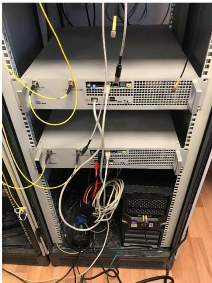
Рисунок 2 – Комплекс квантовой криптографической аппаратуры: высокоскоростные криптографические шифраторы 10G
