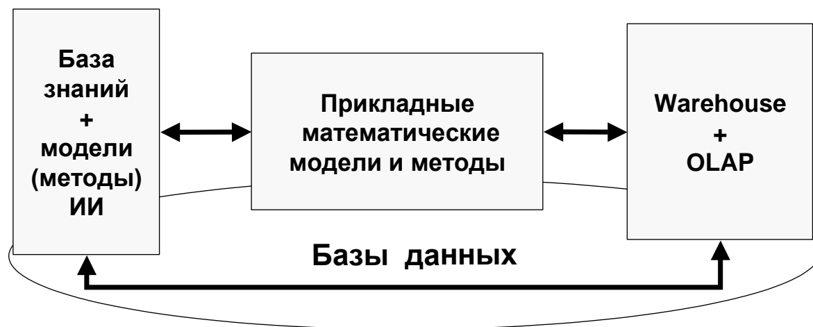
Рисунок 1 – Структура системы поддержки принятия решений
