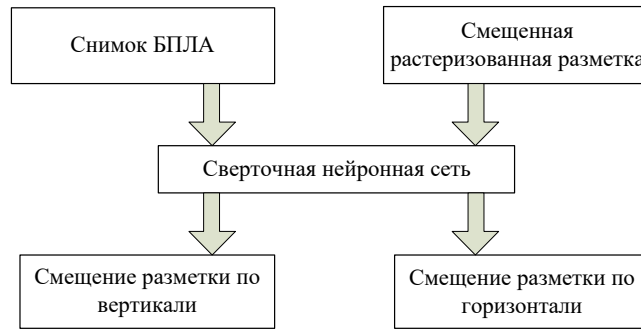
Рисунок 2 – Разметка графических снимков с коррекций проекции сверточными нейронными сетями
