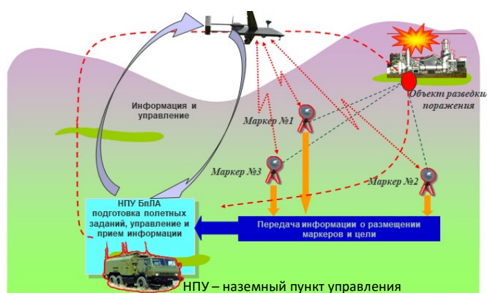
Рисунок 6 – Принцип действия интегрированной РНС на основе наземных маркеров
