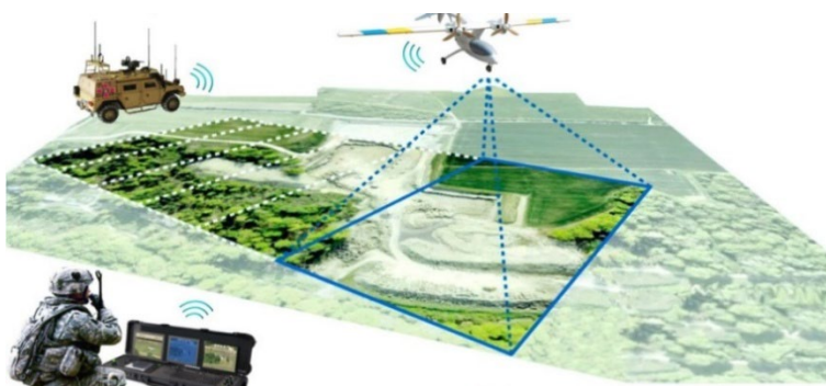
Рисунок 5 – Навигация летательного аппарата (ЛА) по рельефу
