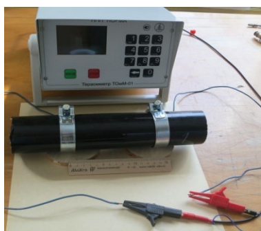
а) наружные стальные электроды на образце многослойной резины
