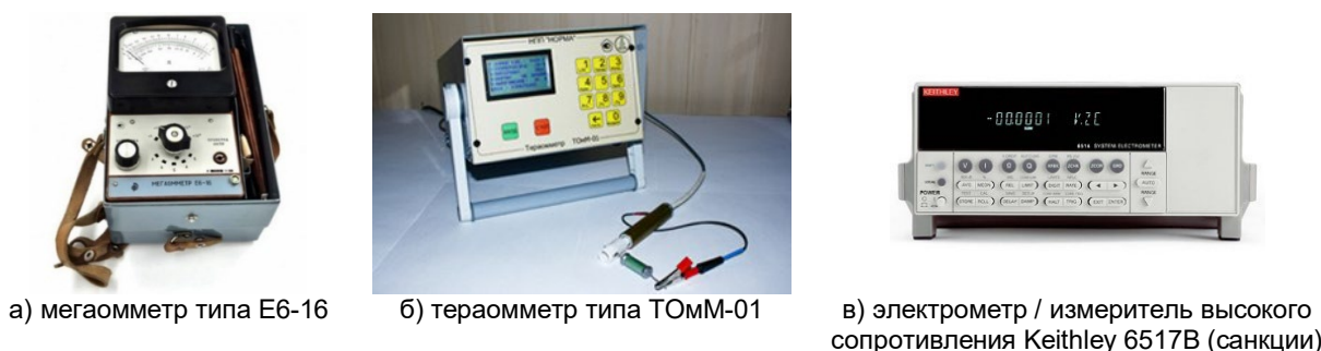
Рисунок 4 – Внешний вид средств измерений удельного электрического сопротивления образцов
