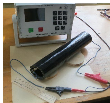
б) внутренние стальные электроды на образце многослойной резины
