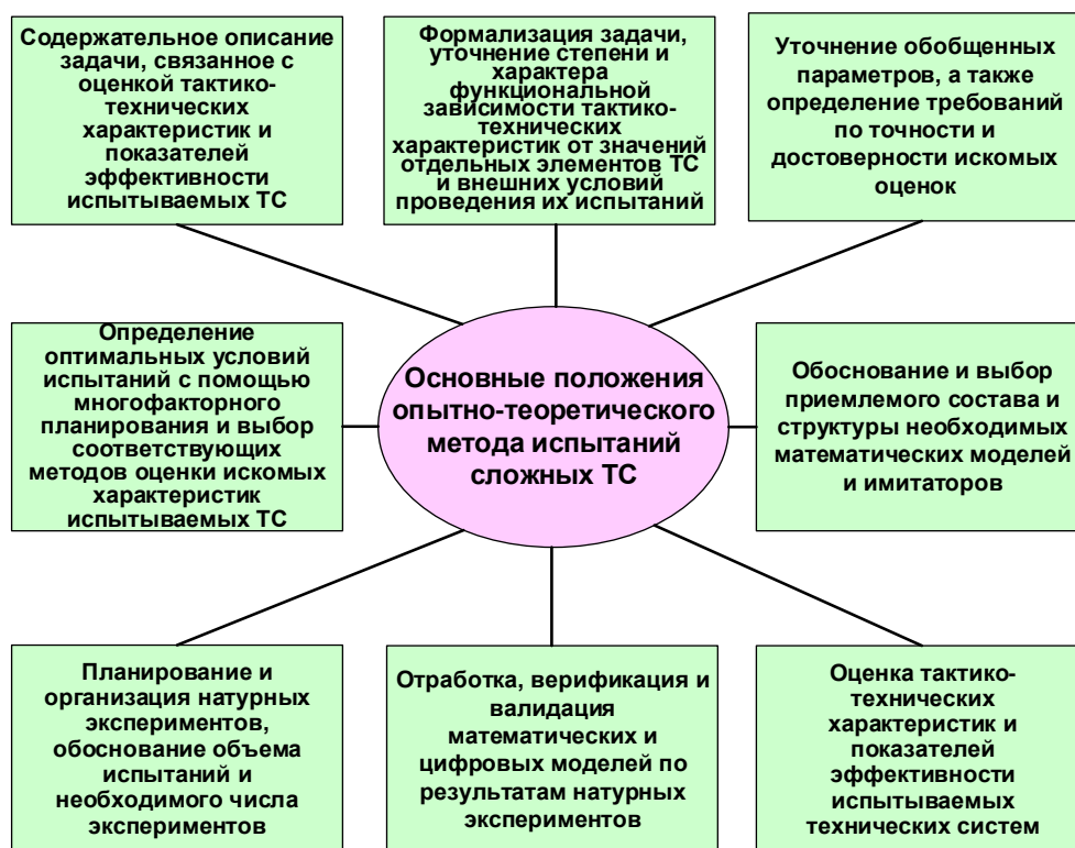
Рисунок 1 – Основные положения опытно-теоретического метода испытаний сложных технических систем
